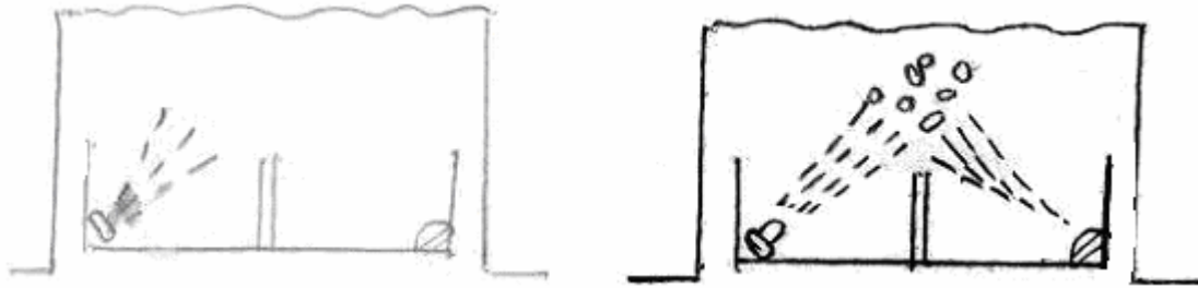
شكل ٣ - ٦ عمل الكاشف الكهروضوئي بطريقه تشتت الضوء
