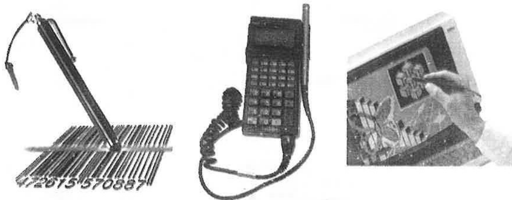
الشكل (2-14) أشكال من القلم الضوئي واستخداماته
