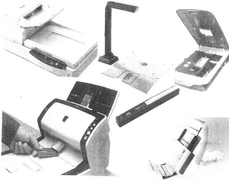
الشكل (2-12) أنواع مختلفة من الماسحات الضوئية (حسب حجم المستندات، وطريق الاستخدام)
